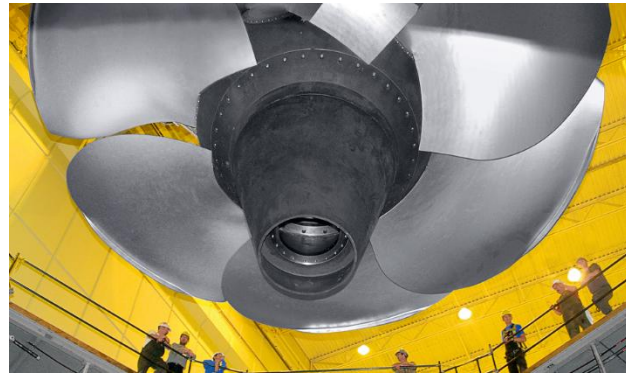
Voith-Kaplan turbine, 200 MW, diameter 10.5m
