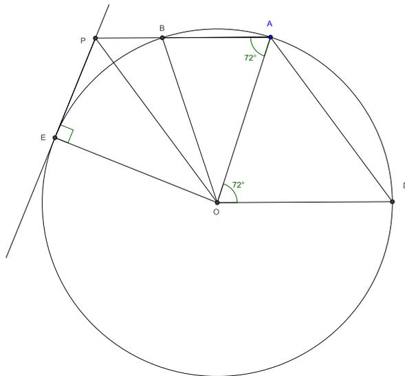
Par le point (5) ci-dessus,  $\overline{AB} = c_{10}$  et  $\overline{AB}^2 = \overline{PA} \cdot \overline{PB}$  (car  $\overline{AP} = \overline{OD}$ ). La droite  $PE$  est tangente au cercle et la droite  $PA$  coupe le cercle en B ainsi :
