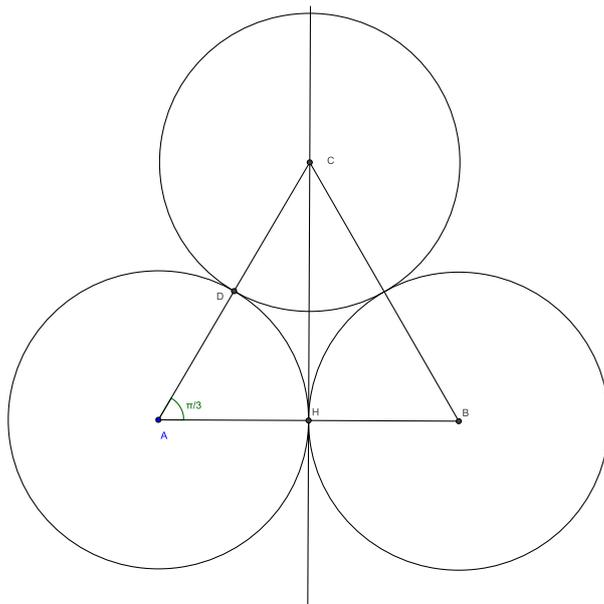
Le triangle  $\triangle ABC$  est équilatéral car chacun des côtés mesure  $2r$ , ainsi l'angle  $\widehat{CAB}$  mesure  $60^\circ = \frac{\pi}{3}$  rad. Nous allons calculer l'aire du triangle  $\triangle ABC$  auquel nous enleverons l'aire des trois secteurs circulaires d'aire égal à celui du secteur  $ADH$ . Par le théorème de Pythagore,  $\overline{CH}^2 = (2r)^2 - r^2 = 3r^2$
