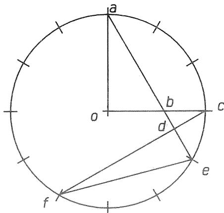
Le cercle C est partagé en douze parties isométriques. Calcule la mesure des angles des triangles *oab*, *bcd* et *def*.
