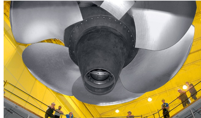
Voith-Kaplan turbine, 200 MW, diameter 10.5m
