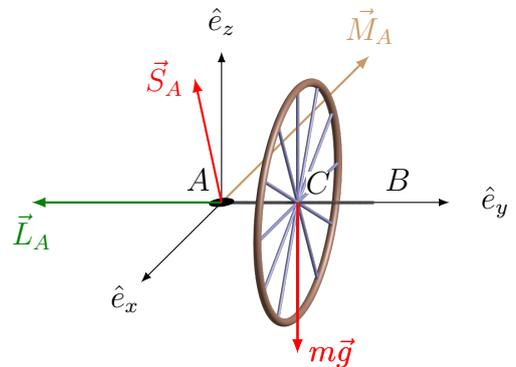
L'axe de la roue pivote autour de l'axe vertical passant par  $A$  : c'est un mouvement de précession. A cela vient s'ajouter une inclinaison de l'axe de la roue par rapport à l'horizontale, inclinaison qui dépend de la vitesse angulaire de rotation de la roue : plus la vitesse de rotation de la roue est grande, plus l'inclinaison est faible. A ce mouvement se superpose enfin une oscillation de cette inclinaison, appelée nutation.
