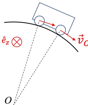
Par conséquent, puisque le châssis est un solide indéformable, son centre de rotation instantané se situe en  $O$ . Enfin, en utilisant que la vitesse angulaire  $\dot{\theta}$  est liée à la vitesse du point  $G$  par  $v_G = (R + h)\dot{\theta}$ , on déduit que le vecteur vitesse de rotation instantanée du châssis s'exprime comme  $\vec{\Omega} = \dot{\theta}\vec{e}_z = \frac{v_G}{R+h}\vec{e}_z$ , où  $\vec{e}_z$  pointe dans la page, comme indiqué sur la figure.
