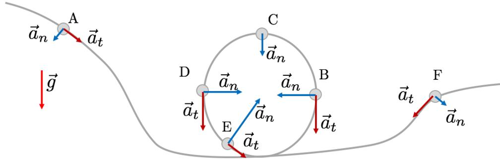
La figure suivante permet d'analyser la situation point par point. Le vecteur  $\vec{N}$  représente la force liée à la contrainte géométrique et  $\vec{g}$  est l'accélération due à l'attraction terrestre. On a considéré une masse  $m$  unité. Le rectangle qui apparaît pour certains points correspond à la décomposition du vecteur  $\vec{g}$  en ses composantes normales et tangentielles au mouvement.
