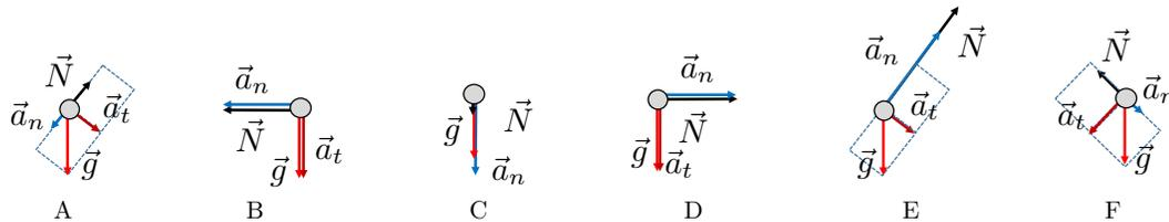
Le wagonnet subit deux forces : son poids  $m\vec{g}$  et la force de liaison  $\vec{N}$ , donc  $m\vec{g} + \vec{N} = m\vec{a}$ , c'est-à-dire  $\vec{a} = \vec{g} + \vec{N}/m$ .
