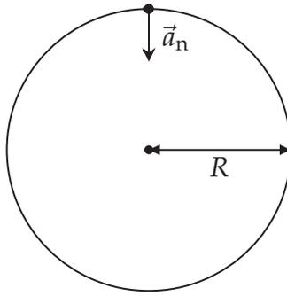
La bille est soumise à une force **centripète** (orientée vers le centre de la trajectoire) de la part de l'anneau. D'après la troisième loi, la bille exerce sur l'anneau une force **centrifuge** (orientée vers l'extérieur). L'intensité de ces forces se calcule aisément :
