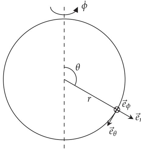
On se propose de calculer l'angle  $\theta$  en fonction de  $\dot{\phi}$ , en supposant que la bille glisse sans frottement, ce qui implique que la réaction de l'anneau est perpendiculaire à l'anneau (voir chapitre 4). Le système est donc soumis à cette réaction (force de liaison) et à son poids, dont la projection est
