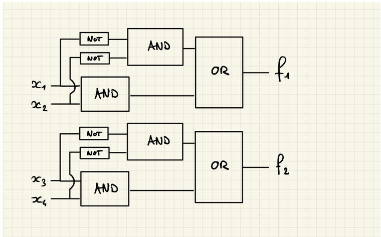
b\*) Pourquoi ce cas, il suffit en fait d'inverser les sorties  $f_1$  et  $f_2$  pour obtenir ce qu'on veut!
