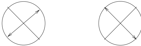
Figure 5.3 Orientations du polariseur pour la préparation des photons dans la base X .
