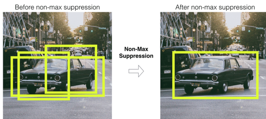
FIGURE 3 – La suppression des doublons (Non-Maximum Suppression) permet de réduire le nombre de « bounding boxes » redondantes et/ou partielles.
