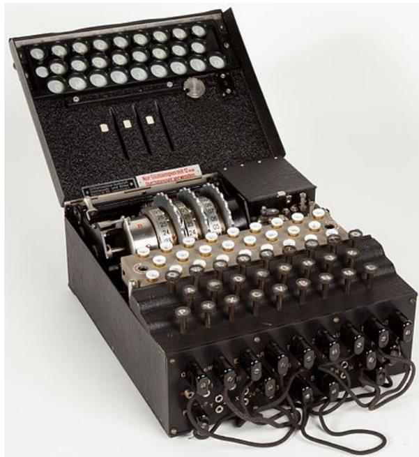
Le principe de base de la machine est le suivant : celle-ci est composée (entre autres) de deux claviers, et chaque frappe d'une touche du clavier du bas déclenche l'allumage d'une autre touche du clavier du haut, par un système de connexions électriques que nous allons détailler. Par exemple, pour un réglage donné, en écrivant le mot BONJOUR sur le clavier du bas, on voit s'allumer la séquence de lettres AIOZAPN sur le second clavier.
