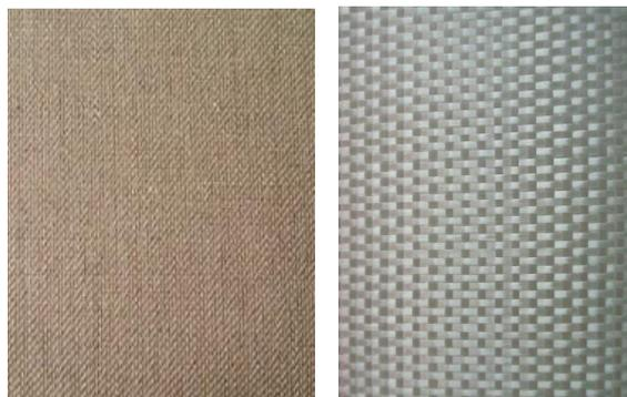
Figure 1: Fibres de Lin et fibres de Verre
