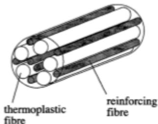
Le vide entre les fils est simplement comblé par la pression. Indice : calculer le nombre de fibres de carbone pour une fibre de PA12. Taux de vide 20%.
