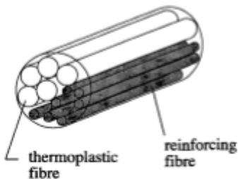
Le vide entre les fils est simplement comblé par la pression. Indice : le taux de vide entre les fibres dans le fil est supposé de 20%
