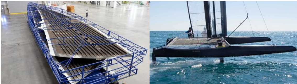
Figure 5 - Eléments d'aile de l'Airbus A350XWB fabriqués en carbone pré-imprégné Source : airbus.com Catamaran Classe C de Hydros.ch réalisé en pré-imprégnés NTPT pour la petite coupe de l'America 2015 Source : decision.ch
