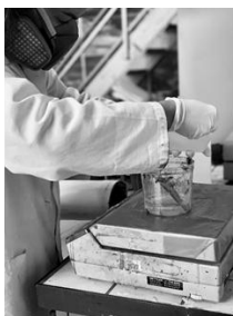
1. Préparation du mélange résine durcisseur
