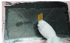
2. Imprégnation des tissus à la main avec une spatule ou un pinceau directement dans le moule ou sur un plan de travail protégé.
