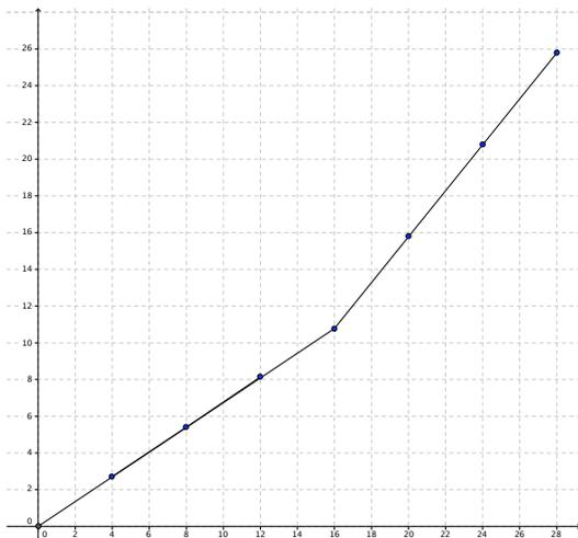
On reporte les points sur le graphe (ou l'axe des abscisses représente le volume d'eau en dl et l'axe des ordonnées celui de la hauteur en cm). On observe que les quatre premiers points sont alignés et les quatre derniers également. Cela signifie que le vase a une largeur constante jusqu'à 10,8 cm, puis il se resserre (car le vase se remplit plus vite dès ce moment) et continue avec une largeur constante.
