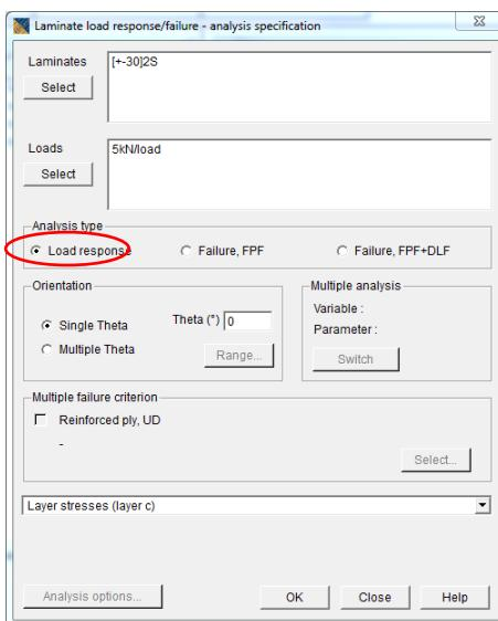
1.5 Le bouton “Load response/failure” vous permet d’obtenir les déformations et contraintes dans chacun des plis en sélectionnant l’analyse “Load response”.
