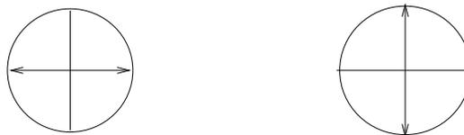
**Figure 5.2** Orientations des polariseurs pour la préparation des photons dans la base Z.
