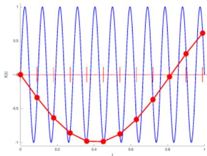
Ce phénomène s'appelle l'**effet stroboscopique** et survient donc lorsqu'on *sous-échantillonne* un signal. Nous y reviendrons en détail la semaine prochaine.
