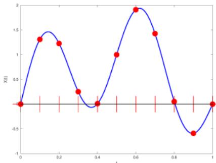
$T_e$  = période d'échantillonnage,  $f_e = \frac{1}{T_e}$  = fréquence d'échantillonnage
